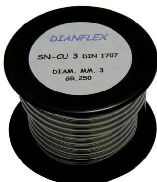
Adatta per brasatura dolce in genere, tubi di rame per impianti di acqua calda e fredda. Composizione: 97 % Stagno, 3 % Rame. Aspetto e Diametro: rotolino, 3 mm. Temperatura di fusione. 230 - 250° C.
